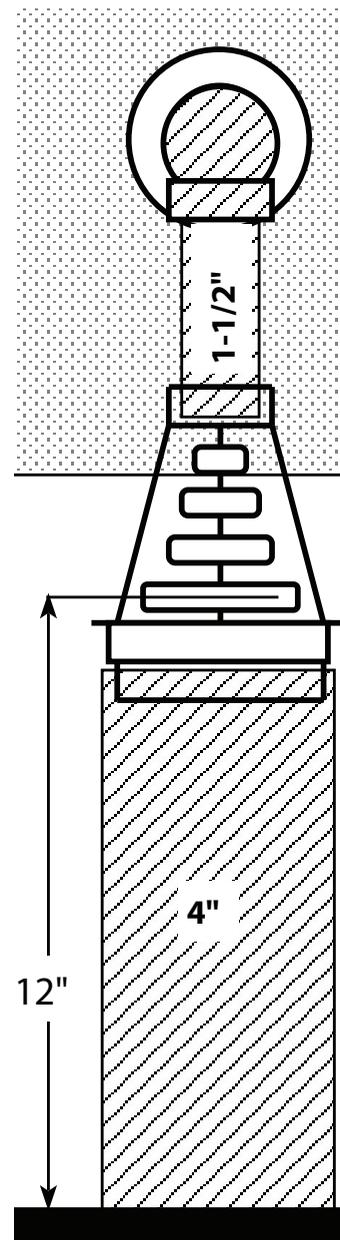
FREEZE RELIEF IS DESIGNED TO GIVE YOUR SUMP PUMP SYSTEM A WAY FOR WATER TO ESCAPE IN CASE THE BURIED DISCHARGE LINE FREEZES. THE MORE DISTANCE BETWEEN THE FREEZE RELIEF VENTS AND THE GROUND THE BETTER.
