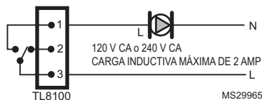
Fig. 3. Diagrama de cableado de un circulador de voltaje de línea.
