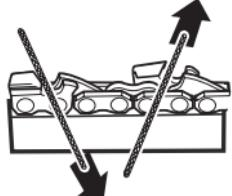
3. Afile la placa superior, la placa lateral y el calibrador de profundidad con una lima plana.
