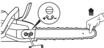
5. Tire de la cadena en el centro de la barra de guía en la parte inferior lejos de la barra, el espacio entre la guía de la cadena y la barra de guía debe estar entre 3 mm y 6 mm.
