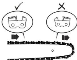
8. Mettez la chaîne en place et assurez-vous que la boucle est derrière le guide-chaîne.
