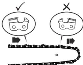
8. Coloque la cadena en su posición y asegúrese de que el bucle esté detrás de la barra de guía.
