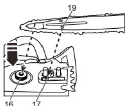
12. Instale la cubierta de la cadena.
