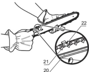
7. Asegúrese de que la cadena se coloque en la dirección correcta (no monte con los cortadores al revés).
