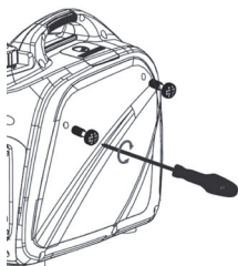
Figura 4-3. Extracción de la cubierta lateral
