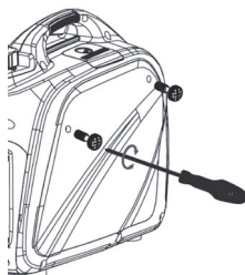
Figura 2-6. Retire la cubierta lateral
