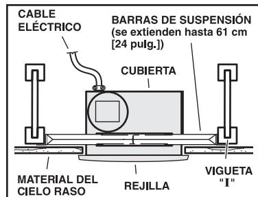
**Montaje de cubierta en viguetas.**
