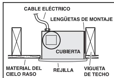
**Montaje de la cubierta en cualquier parte entre las viguetas por medio de barras de suspensión.**
