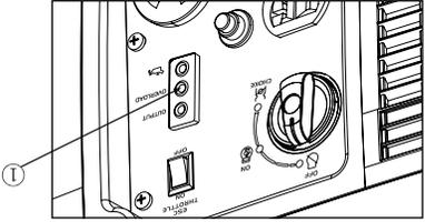
Le voyant de surcharge (1) s'allume lorsque la surcharge d'un appareil électrique raccordé est détectée, lorsque le dispositif de contrôle du convertisseur surchauffe ou lorsque la tension de sortie CA augmente. Ensuite, la protection CA se déclenche, arrête la production d'énergie afin de protéger le générateur et tous les appareils électriques branchés. La lampe-témoin CA (verte) s'éteint et le voyant de surcharge (rouge) reste allumé, mais le moteur ne s'arrête pas.
