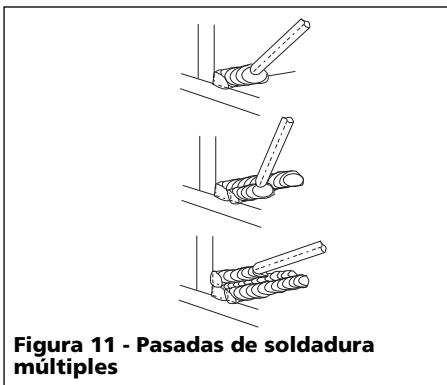
Figura 10 - Pasadas de soldadura
