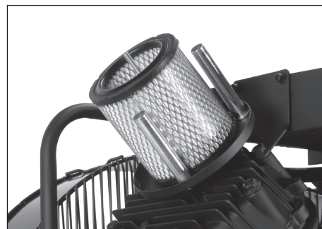
Figure 19 - Filtro de aire
