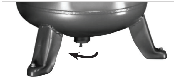
Figure 8 - Drain de réservoir manuel
