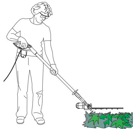
Figura 15 - Podado de follaje bajo o vegetación del suelo
