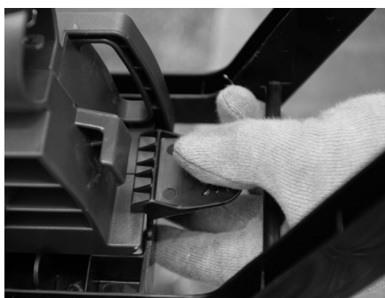
Figura 4-12. Presionando la palanca sujetadora
