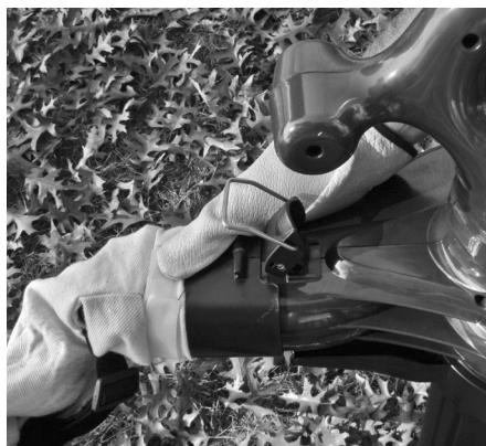
Figure 4-10 : Retrait de l'ensemble adaptateur/sac
