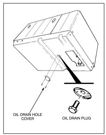
FIGURE 3-2. OIL DRAIN PLUG
