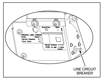
FIGURE 2-1. LINE CIRCUIT BREAKER
