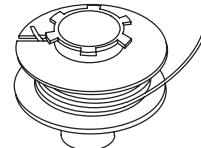
3. Enroulez le fil dans le sens de la flèche figurant sur la bobine, en rangs réguliers entre les rebords de la bobine.
