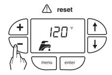
Figure 16-6: Adjusting DHW Setpoint
