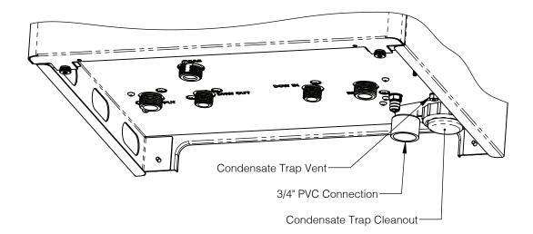
Figure 14-1: Condensate Trap
