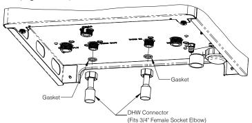
Figure 11-1: DHW Connections
