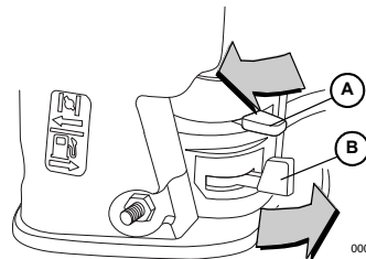
Figura 3-2. Válvula de combustible y cebador NOTA: Para motor caliente, verifique que la palanca del cebador esté en posición OPEN (Abierto).
